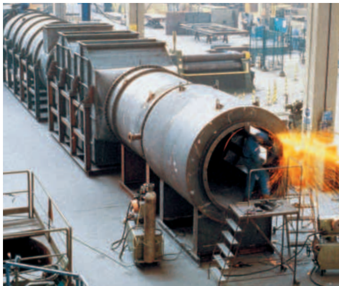
Stabilimento Babcock Wanson Italiana Combustore recuperativo da 45.000 Nm 3 /h in costruzione
