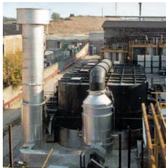
Spalmatura tessuti • 50.000 Nm 3 /h Ricupero calore in olio diatermico
