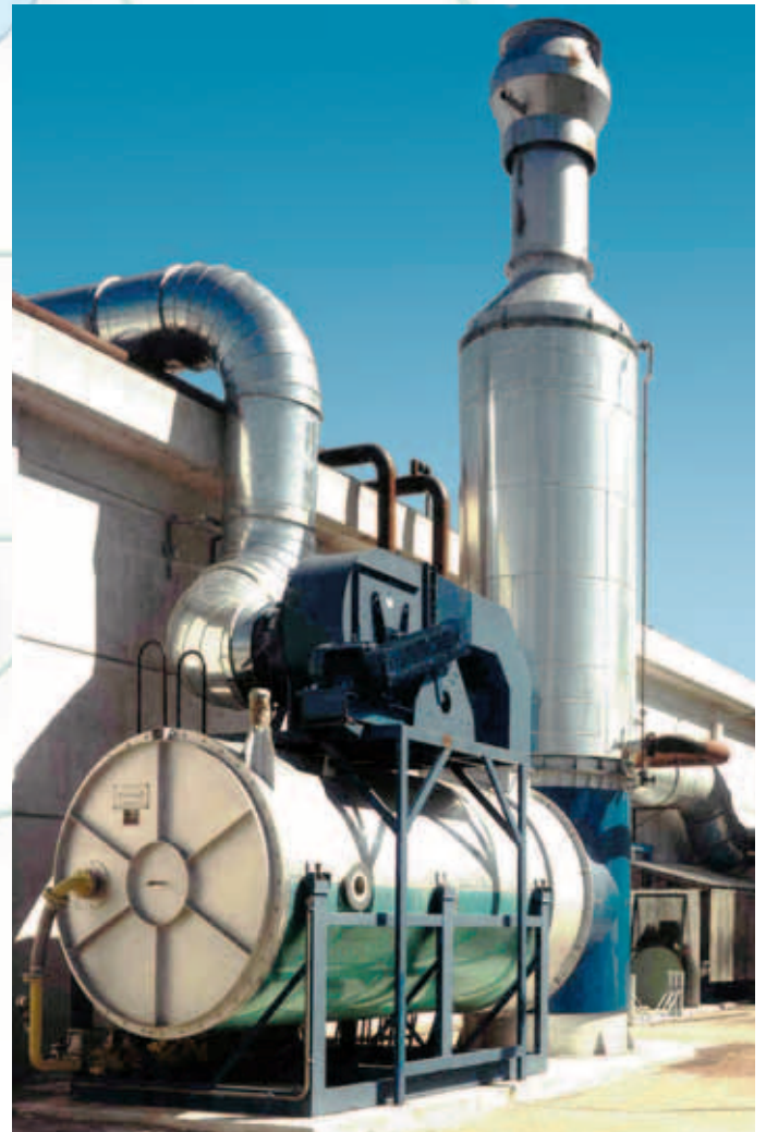
Produzione finta pelle Ricupero calore in olio diatermico • 20.000 Nm 3 /h
